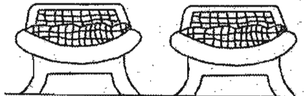
လေမှုတ်သွင်းဆီစာထိုင်ခုံပုံကြမ်းကို ရေ့ဘက်မှ မြင်ရပုံ (မထိုင်ခင် ပိုလောက်နေပြီး ထိုင်လိုက်လျှင် အိတ်သွားသည်ဆီစာများ)
