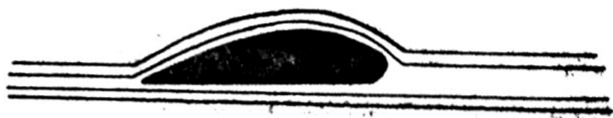
ပုံ ၂။ လေယာဉ်အတောင်ပေါ် လေဖြတ်တိုက်နေပုံ
