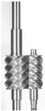
ပုံ ၁၄-၂၃ Twin screw compressor rotors
