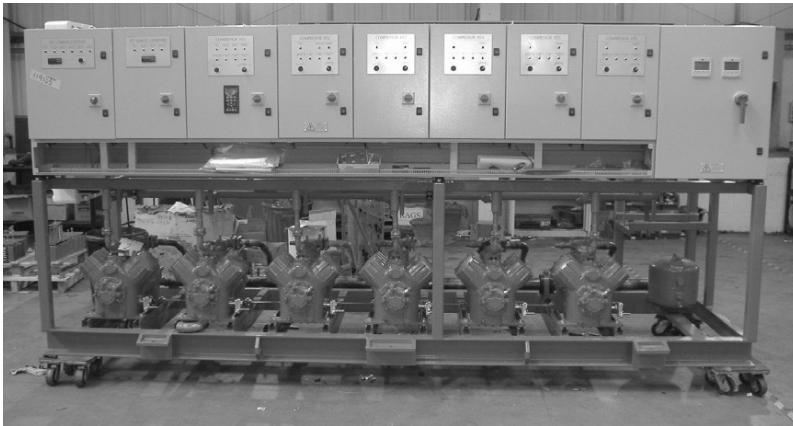
ပုံ ၁၃-၃ Semi-hermetic compressor pack
