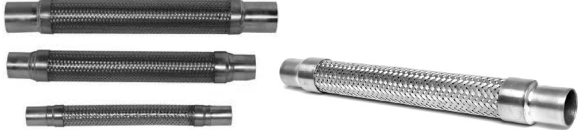
ပုံ ၁၀-၁၅(ခ) Discharge line နှင့် suction တွင် တုန်ခါမှုလျော့နည်းစေရန် vibration absorber တပ်ဆင်ထားသည်။
