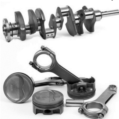
ပုံ ၁၃-၁၆ Crank shaft ၊ connecting rod ၊ cylinder ၊ piston နှင့် piston pin
