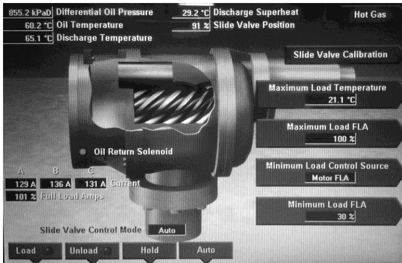
ပုံ ၁၄-၅၀ လည်ပတ်နေသည့် screw chiller တစ်လုံး၏ compressor data များ
