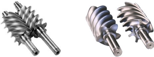
ပုံ ၁၄-၁၆ Helical-rotary screw
