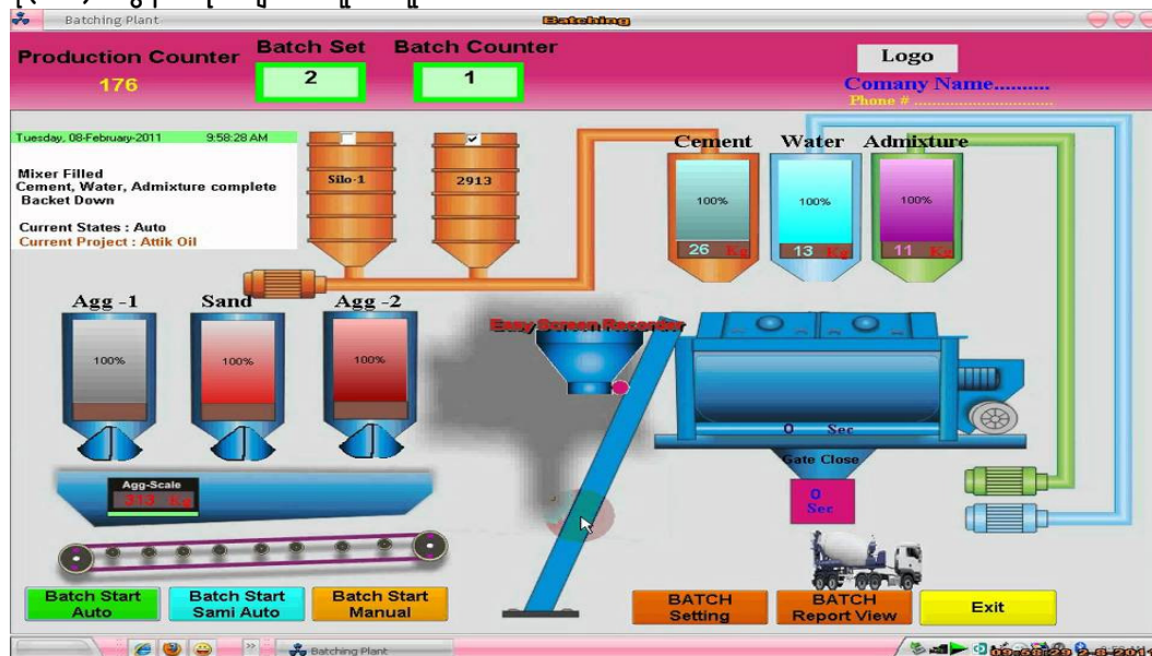
ပုံ(1.3) ကွန်ကရစ်ဖျော်စက်ရုံကို ကွန်ပျူတာဖြင့် Control လုပ်ပုံ
