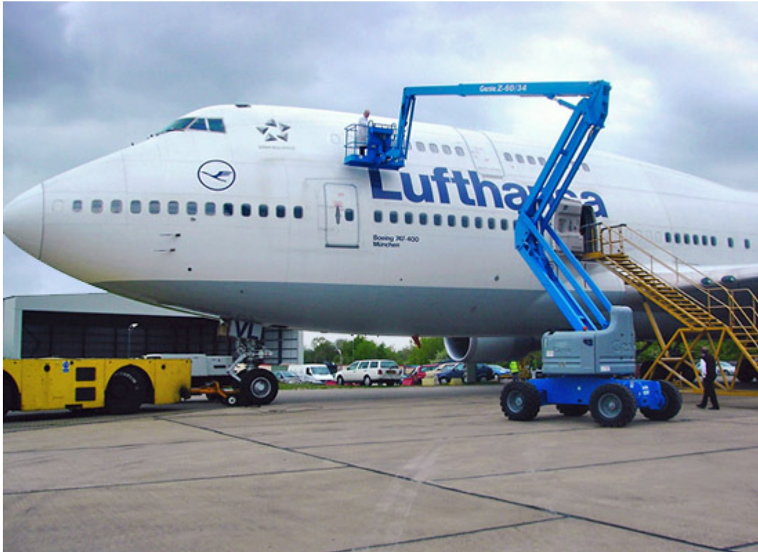
ပုံ (3.10) Genie ကုမ္ပဏီမှ ထုတ်လုပ်သော Z-60/34 Articulating Boom Lift အသုံးပြုပြီး အလုပ်လုပ်နေပုံ
