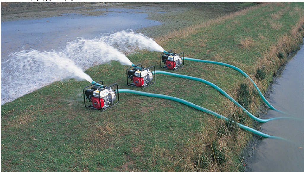
ပုံ (4.14) ဓာတ်ဆီအင်ဂျင်ပန် အလုပ်လုပ်ပုံ
