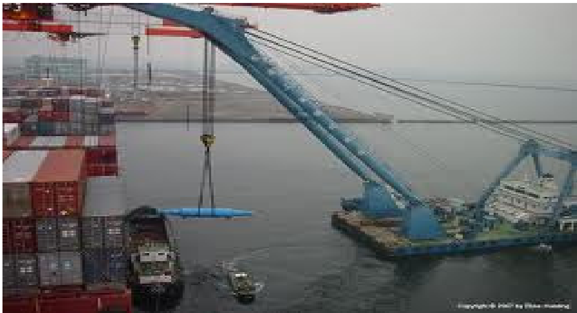
ပုံ(၂.၁) Floating Crane ဖြင့် မရွှံ့ ချနေပုံ
