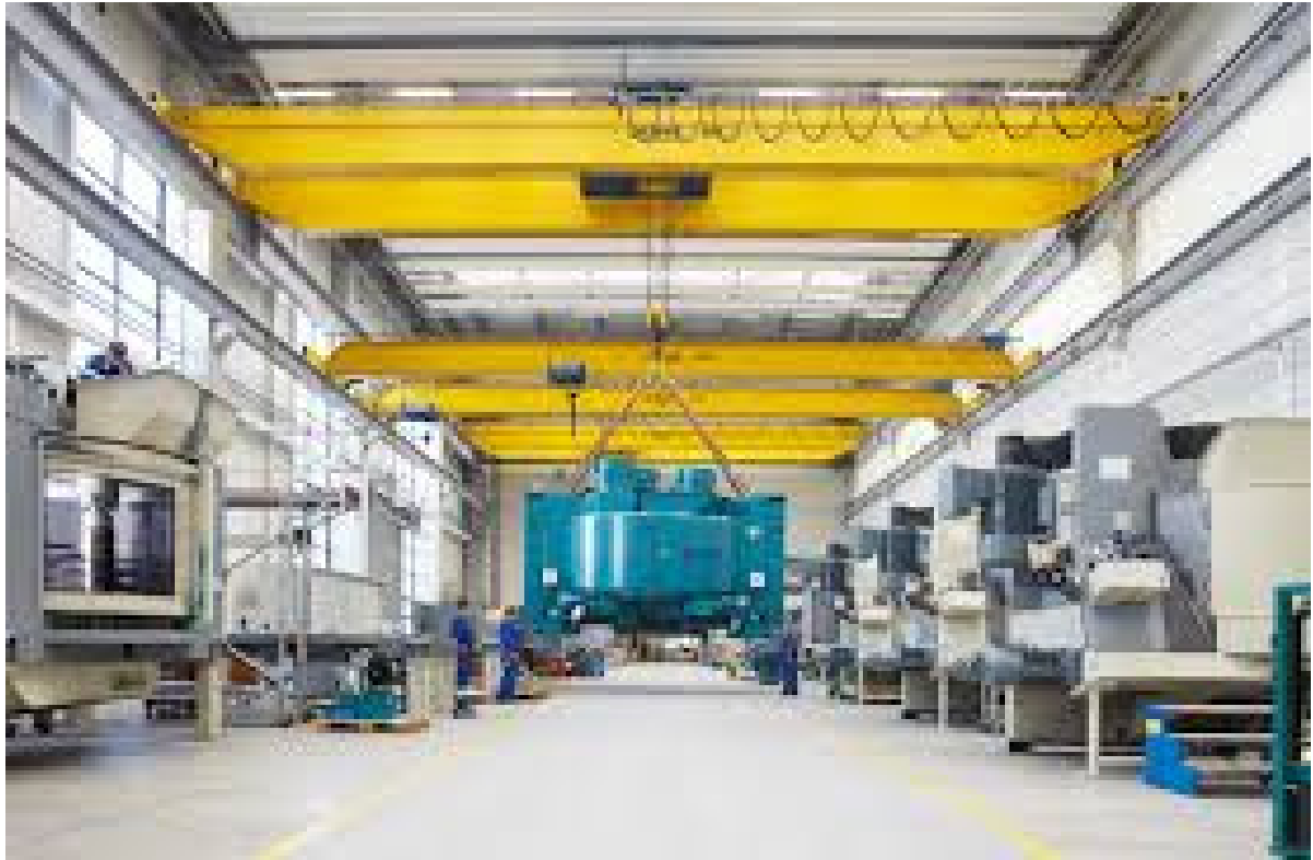
ပုံ(၂.၁၅) overhead crane အသုံးပြုပြီး တပ်ဆင်ခြင်း
