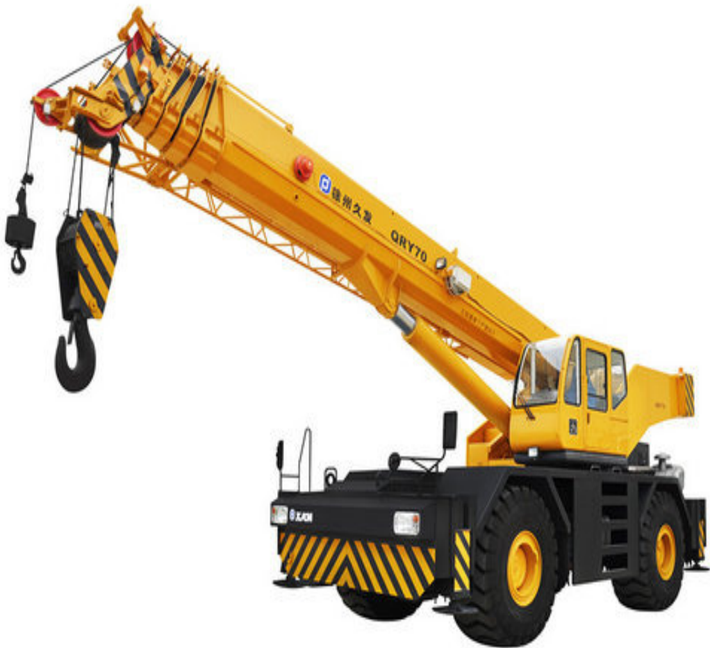
ပုံ(၄.၁) Rough-Terrain Crane QRY70 (China Crane) 70 Ton
