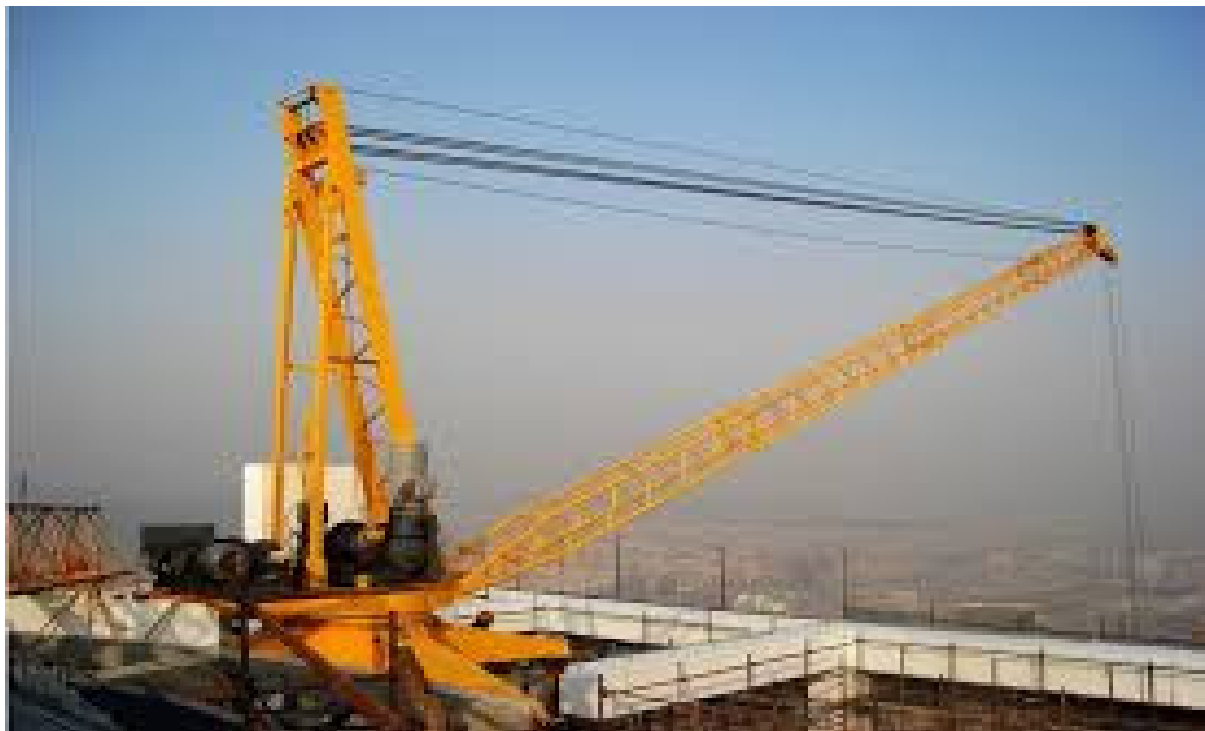
ပုံ(၂.၅) ဆိပ်ကမ်းမှာရှိတဲ့ Derrick Crane အသုံးပြုပြီး အတင်အချပြုလုပ်ခြင်း
