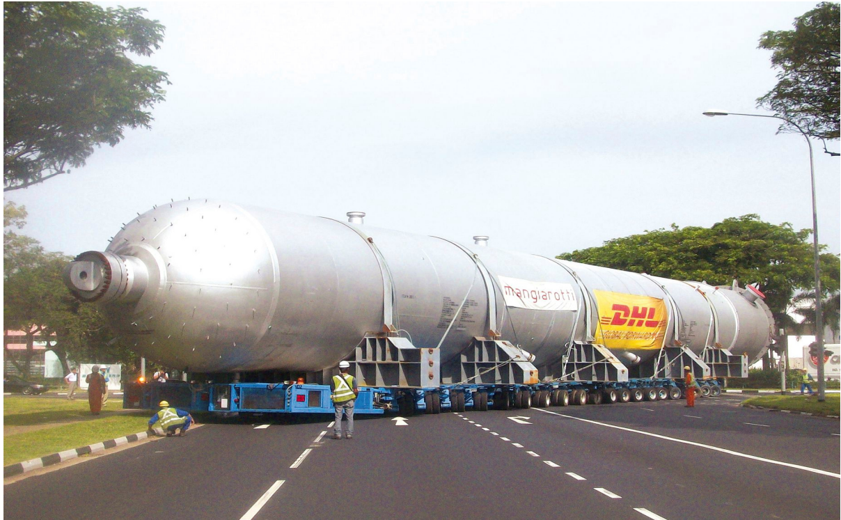
ပုံ (၇.၂) SPMT ဖြင့် ကြီးမားလေးလံရှည်လျားသောပစ္စည်းကို သယ်ယူပို့
