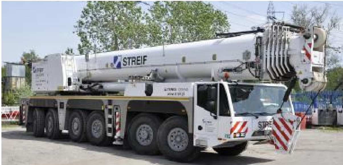
ပုံ(၄.၂) All-Terrain Crane –Demag AC250 (250 Ton Crane)
