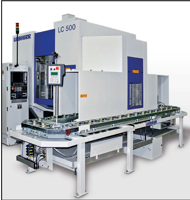
အထက်ပါပုံတွင် LIEBHERR CO.,က ထုတ်လုပ်သော Model-LC 200-500 The Hobbing Machine ပုံ ဖြစ်ပါသည်။
