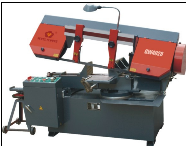
အထပ်ပါပုံသည် Reciprocating Motion ကို အသုံးပြုထားသော Horizontal Band Saw Machine ဖြစ်ပါသည်။
