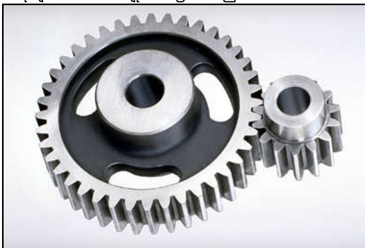
Spur gear ဂီယာတစ်စုံတွင် ငယ်သောဂီယာကို Pinion လို့ခေါ်ပြီး ကြီးသောဂီယာကို Gear လို့ခေါ်ပါသည်။ လိုသောလည်ပတ်နှုန်းတွေရရှိဖို့အတွက် ဂီယာသွားအရေအတွက်ကို တွက်ချက်ရပါသည်။
