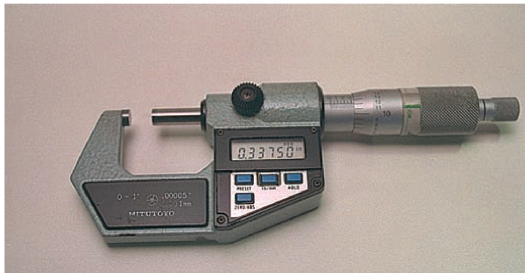
Fig (2-19) Digital micrometer eliminates the need to do math. (ဒီဂျစ်တယ်သုံးရင် တော့တွက်စရာမလိုတော့ပါ)
