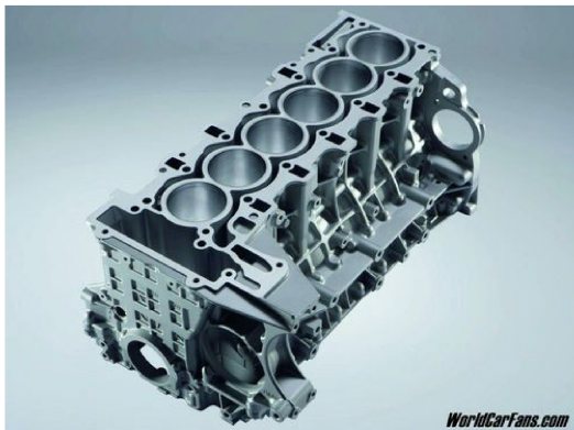
Figure (3-6) Inline Engine Block (ဆလင်ဒါခြောက်လုံးထိုး အင်လိုင်းအင်ဂျင်ဘလောက်ပုံ)
