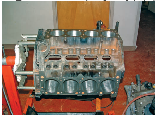
Figure (3-2) A cylinder block for an eight-cylinder engine (ရှစ်လုံးထိုးဆလင်ဒါဘလောက်တစ်လုံး)
