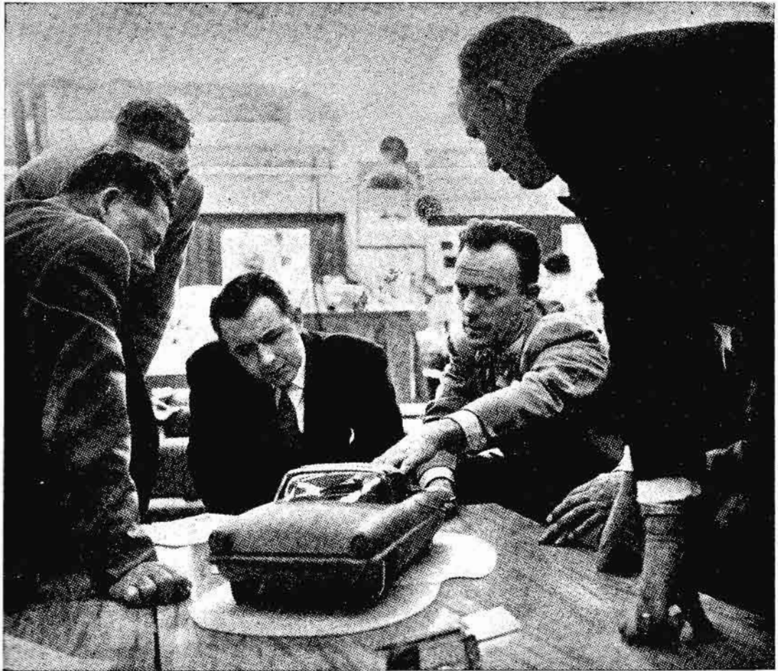
မော်တော်ယာဉ်ပုံအသစ် မထုတ်လုပ်မီပုံစံကိုရှေးဦးစွာထုတ်ရသည်။ ထိုပုံစံကိုအဖက်ဖက်မှစစ်ဆေးစမ်းသပ်၍ ကျေနပ်ဖွယ်ရှိမှပုံသစ်ထုတ်လုပ်သည်။
