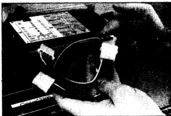
Figure 17.3 Y-connector သည် အပိုဓာတ်အားဆက်သွယ်မှုအဖြစ် အဆင်သင့် ရှိထားဖို့ ကောင်းသည့်ပစ္စည်းတစ်ခုဖြစ်၏။
